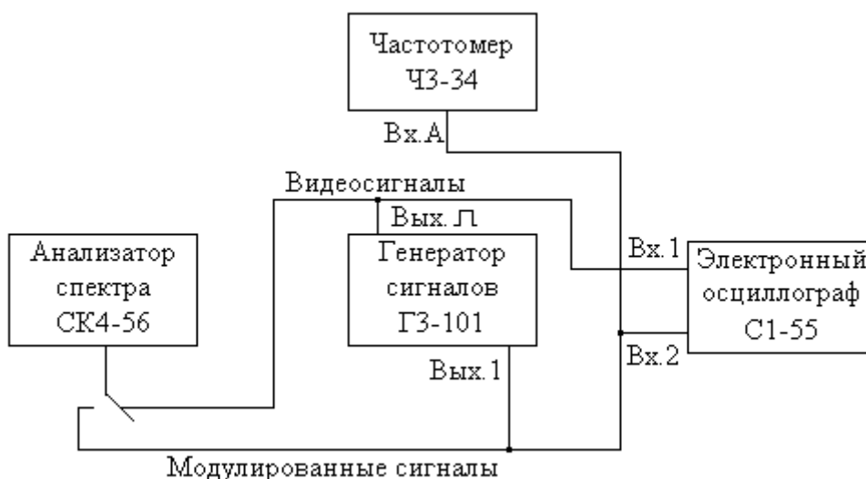
Рис. 1.Схема лабораторной установки для исследования спектров сигналов на основе аппаратных средств
