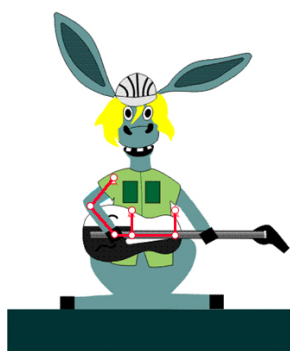
Рис. 6. Gif-анимация: движущаяся кинематическая схема объясняет движение деталей игрушки (студенческая работа)
